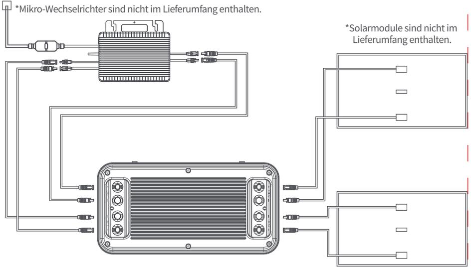
Haben Sie die Mikro-Wechselrichter gemäß der oben aufgeführten Schritte angeschlossen und stellen fest, dass diese nicht ordnungsgemäß funktionieren, gehen Sie bitte wie folgt vor: Schließen Sie einen der Mikro-Wechselrichter an den Ausgang 1 des Produkts an und nehmen Sie den anderen Mikro-Wechselrichter entweder außer Betrieb oder schließen Sie ihn direkt an ein Solarmodul an.
